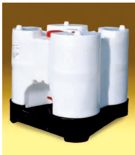
Transicuba plástico 800 lts., Dim. 1160x1160x1155 mm. Válvula de venteo, Tapa Roscada DN 150, válvula de esfera DN 50. Peso en vacío 81 Kg,
