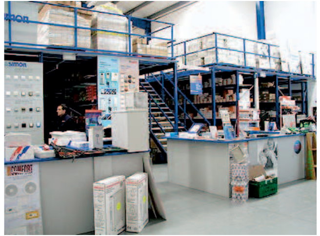
Entreplanta con Estantería de Picking-Expositor
