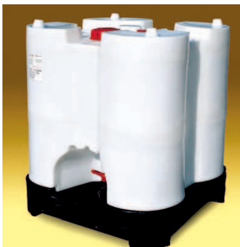
Transicuba plástico 1.000 lts., Dim. 1160x1160x1355 mm. Válvula de venteo, Tapa Roscada DN 150, válvula de esfera DN 50. Peso en vacío 89 Kg,
