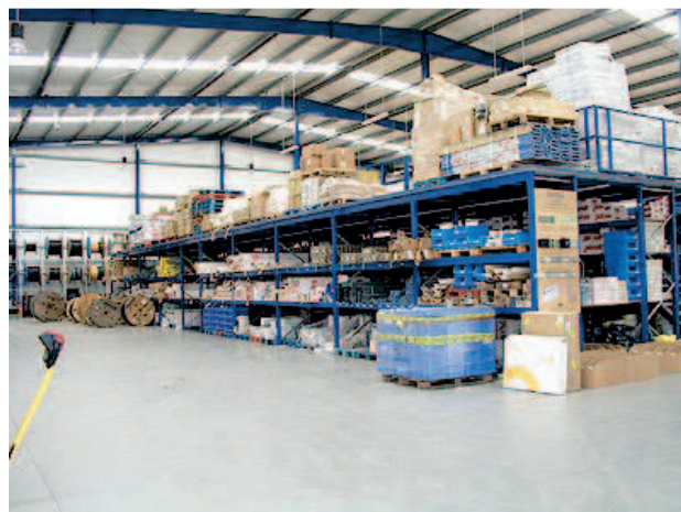
Entreplanta de Paletización convencional en combinación con Picking.
