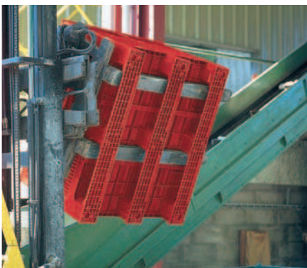
Resistencia de los Patines a repetidas vueltas por Vuelco .
